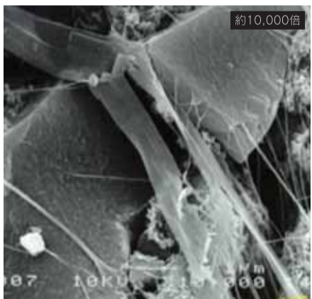
活性炭の表面積は1g当り1,000~3,000㎡と言われ、ウルトラキャパシタは、その巨大な表面に電解イオンを吸着させ蓄電する。
